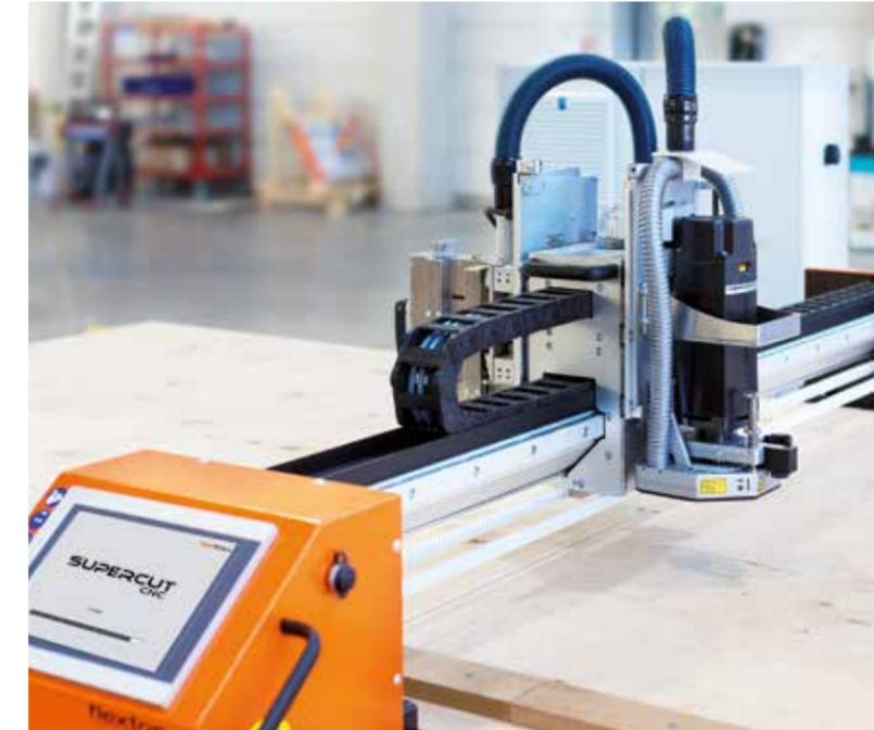
Flextos SUPERCUT CNC Portal mit Fräs- und Sägeaggregat (Foto: Flextos)
